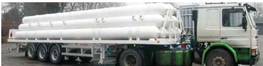
Abbildung 37: Low-Pressure Mobile Pipeline (LMP) Bulk Transportation System von Energtek (Quelle: Energtek)
