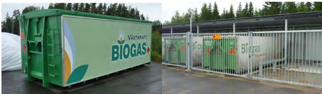
Abbildung 39: Mobiler Gasspeicher zur Versorgung von Biogas-Inseltankstelle (Quelle: New Energy)
