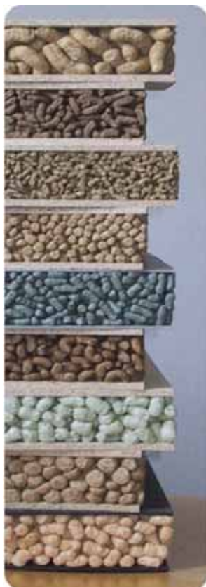
Abb.: Einbauteile in Sandwichbauweise aus nachwachsenden Rohstoffen
