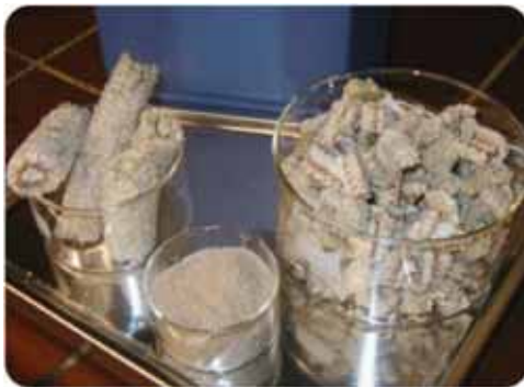
Abb.: Vom Maiskolben zum Granulat
