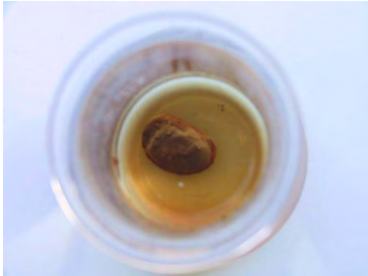
Abbildung 26: Wasserlagerung eines mit propoxyliertem Lignin umhüllten Gesteinskornes
