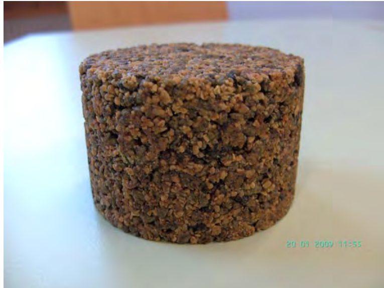
Abbildung 4: Asphaltprobekörper mit einem Nawaro-basierenden Polymer als Bindemittel
