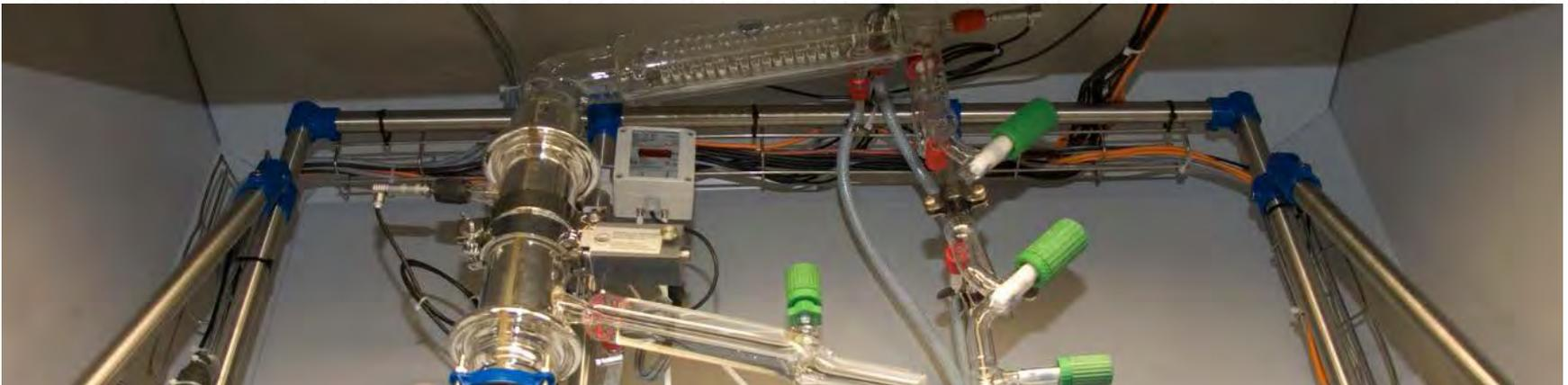
*“Green Safer Solvent“ -Veresterung Milchsäure mit Ethanol zu Ethyllactat mit Hilfe reaktiver Trennverfahren*
