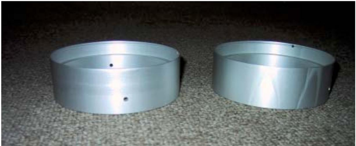
**Abbildung 47: Spuren von Überbeizen durch Spülfehler (rechts), Fehler durch Verrutschen des Spannfutters (links)**
