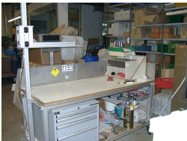
Abbildung 1: Messtisch zur Bestimmung der Ballendimensionen (Quelle: Österreichisches Forschungsinstitut)
